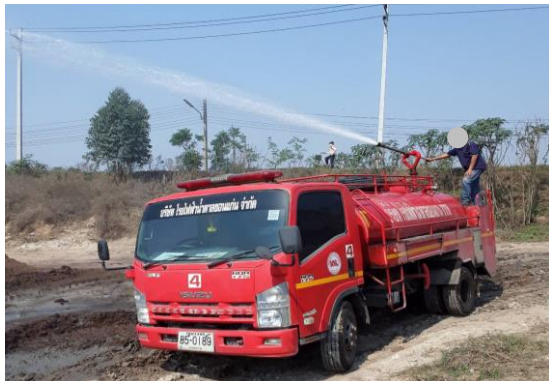
รูปที่ 13 การฉีดพรมน้ำบริเวณผิวหน้ากองกากตะกอนหม้อกรอง
