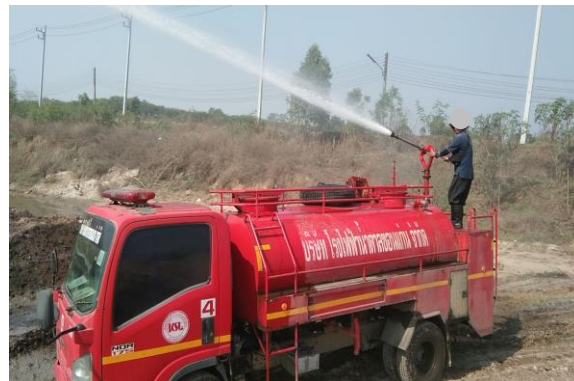
รูปที่ 13 การฉีดพรมน้ำบริเวณผิวหน้ากองกากตะกอนหม้อกรอง
